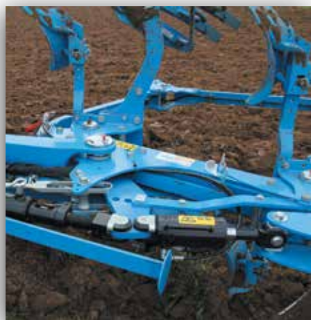
Hydraulik för arbetsbreddsinställning
