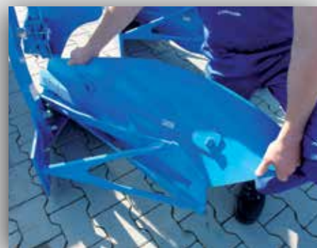
LEMKEN DuraMaxx vändskivor och spalter med bara två krokar
