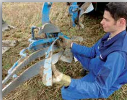
LEMKEN DuraMaxx delar kan enkelt bytas helt utan verktyg
